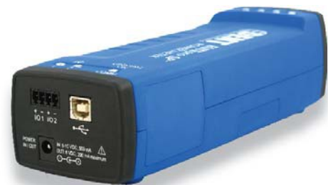
Connessione diretta con porta USB o Ethernet, scarica tutti i 16MB di file dati in meno di 5 minuti
